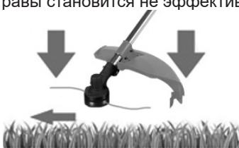
В состав катушки с режущей леской входит нажимная головка, которая позволяет удлинять режущую леску без остановки двигателя. Для этого достаточно слегка ударить нажимной головкой о землю при работе триммера на высоких оборотах. Леска удлинится на 2-3 см. Нож ограничителя длины лески, установленный на защитном кожухе, служит для ограничения ее длины.
